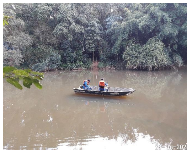
Foto 4 – Detalhe das atividades da medição de vazão no PHJ – 9ª Campanha (Data: 23/06/20).
