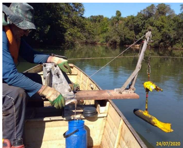
Foto 6 – Detalhe da Campanha de medição de sedimentos no PHM - 11 a C. (Data: 24/07/2020).
