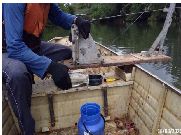
Foto 8 – Detalhe da Campanha de medição de sedimentos no PHJ – 11ªC. (Data: 18/08/2020).
