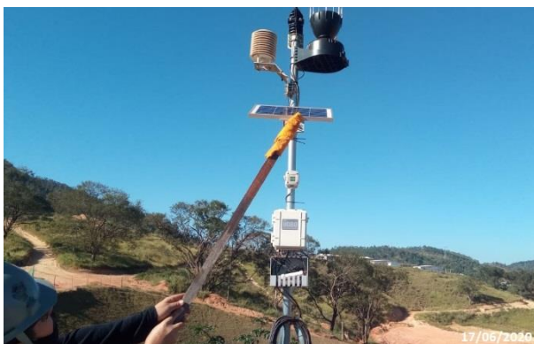
Foto 3 – Limpeza do painel solar da estação. (Data: 17/06/2020).
