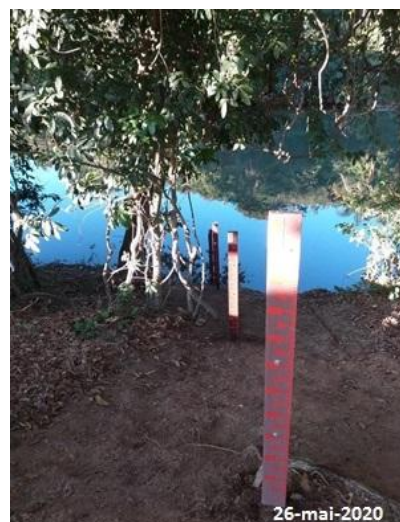
Foto 10 – Visão das régua limnimétrica no PHM – 9ª Campanha (Data: 26/05/2020).
